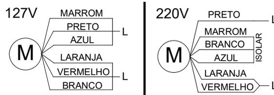
PARA INVERTER A ROTAÇÃO DO MOTOR
